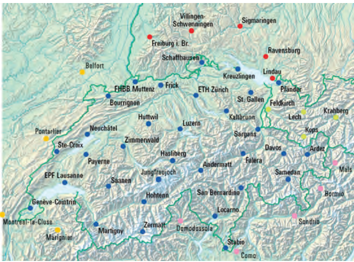
Stationskarte des Automatischen GNSS-Netzes Schweiz (AGNES)
